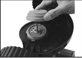
Setzen Sie die obere Abdeckung **13** wieder auf die Radplatte.
