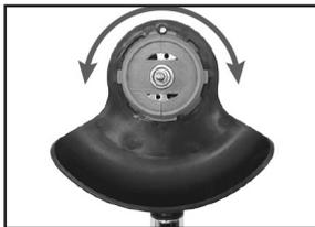
Drehen Sie das kleine Ablenblech **6** sobald Sie es eingesetzt haben, solange bis das kreisförmige Loch des kleinen Ablenblechs **6** oben ist.
