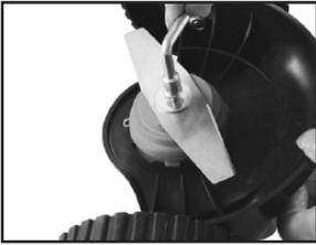
Richten Sie den Einsatz der Metallklinge **7** auf das Loch der oberen Abdeckung **13** aus und setzen Sie die Schraube darüber. Halten Sie die obere Abdeckung **13** mit der Hand fest und ziehen Sie die Schraube mit dem Steckschlüssel **10** fest. Zum Entfernen kehren Sie die Schritte einfach um. Die Metallklingen **7** sind perfekt als Heckenschere und Trimmer von dichtem Unkraut und kleinen Sträuchern.
