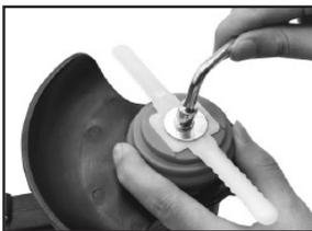
Halten Sie die obere Abdeckung **13** mit der Hand fest und ziehen Sie die Schraube mit dem Steckschlüssel **10** an. Zum Entfernen kehren Sie die Schritte einfach um.
