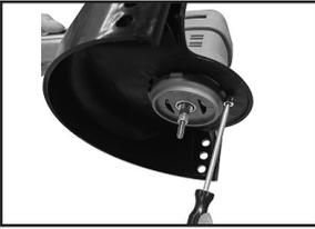
Setzen Sie die Schraube **17** ein, wie in dieser Abbildung gezeigt und drehen Sie sie mit dem Schraubendreher **16** ein.
