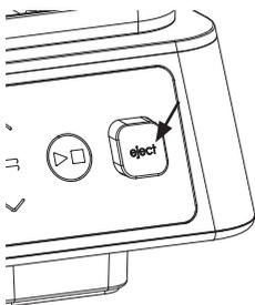
Zum Entnehmen der Platten, die Entriegelungstasten kräftig drücken, um die Platten zu lösen. Platten vom Gerät wegkippen und entnehmen.
