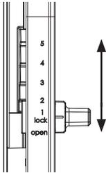
Zum Einstellen öffnen Sie den Grill mit dem Griff und schieben den Abstandsregler auf den gewünschten Wert (1-5). Steht der Abstandsregler auf „open“, lassen sich die Platten komplett schließen.
