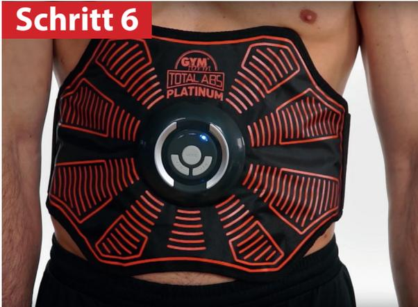
Stellen Sie sicher, dass die Pads korrekt (vollflächig) auf der Haut sitzen und der Gürtel mit den Klettverschlüssen fixiert ist.
